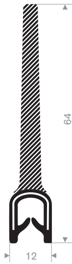
245.00.890 pvc + volrubber klembereik 1,5-4 mm
